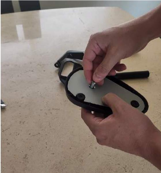
3. Inserta el tornillo que tiene la marca azul dentro de la placa. Si la placa está colocada correctamente, el tornillo debe de quedar al ras.
