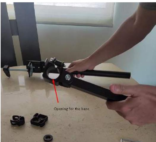
7. Utilizaremos el componente con el brazo con el orificio que se coloca en el poste.
