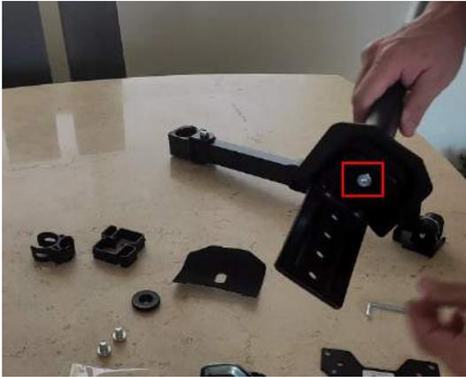
3. Utiliza el tornillo de base cónica para sujeción adicional en la base.
