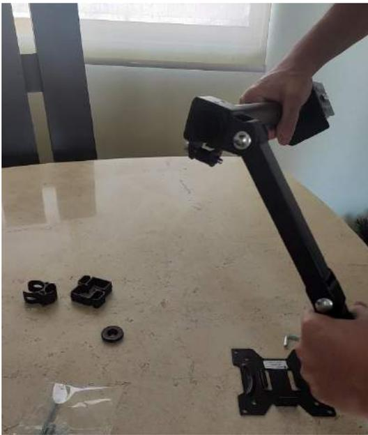
8. Con las tuercas del brazo alineadas hacia abajo, inserta el brazo en el poste. Ajusta con la llave Allen que se proporciona.
