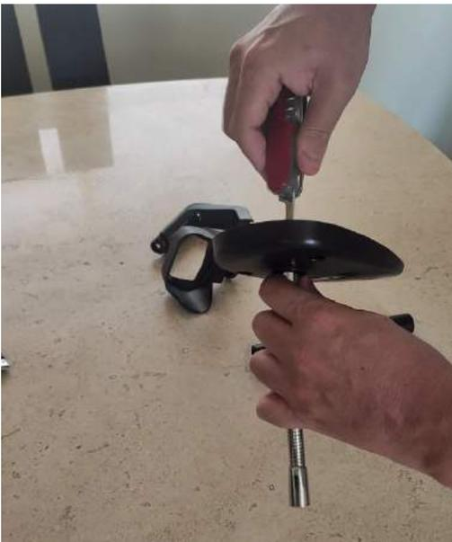
4. Retira el protector plástico del poste y asegura el componente metálico con el tornillo, apriétalo firmemente, y asegurate que quede alineado con las marcas en la base plástica.
