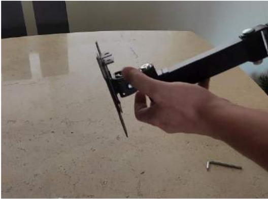
11. Alinea la base al brazo y colócalo en él. Utilizando el tornillo adicional, asegura el monitor al brazo utilizando la llave Allen proporcionada.
