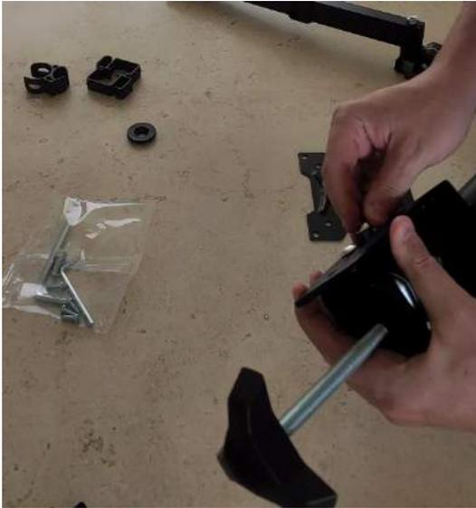
6. Asegura estas dos piezas firmemente utilizando los tornillos plateados.
