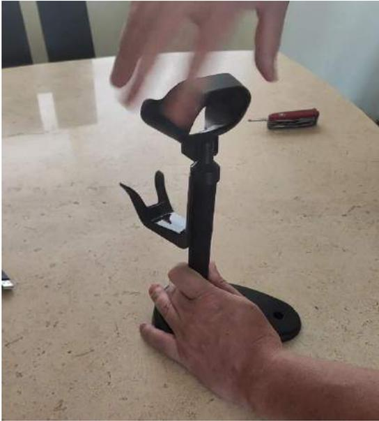
7. Después de ensamblar ambas partes, asegúralas firmemente a la parte superior del poste.
